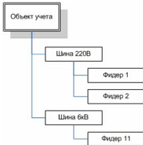
Рис. 5.26. Схема учёта электроэнергии
